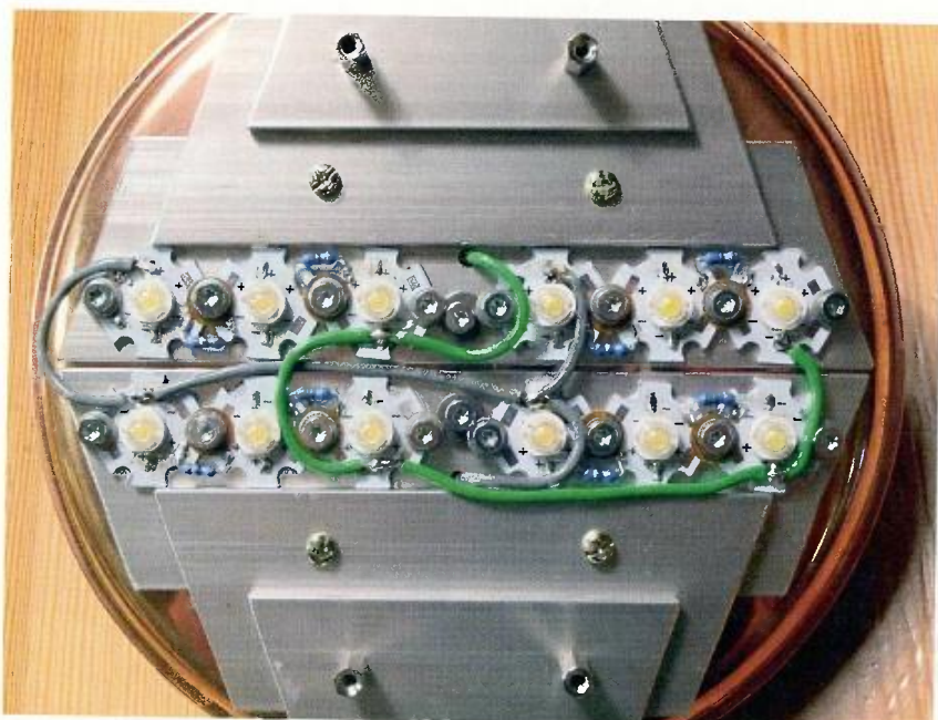
Obr. 3. Diody LED na chladiči a jejich propojení
