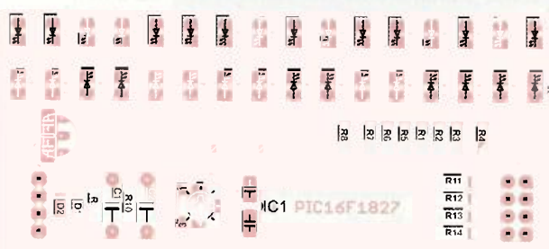
Obr. 2 až 4. Deska s plošnými spoji v měřítku 1:1 (rozměr desky 82 x 36 mm) a rozmístění součástek
