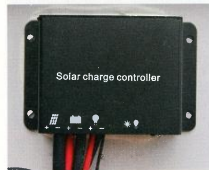
Obr. 9. Regulátor panelu 120 W
